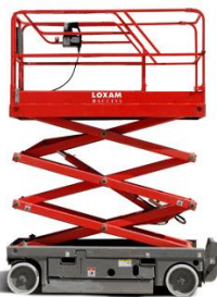
Catégorie A (élévation verticale et automotrice)
