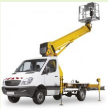
Catégorie B (élévation multidirectionnelle et fixe au sol)
