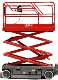
Catégorie A (élévation verticale et automotrice)
