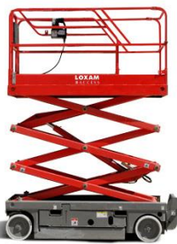
Catégorie A (élévation verticale et automotrice)
